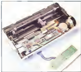
L'interno della Dicomix 150 è molto semplice: si nota il giro motore di governo dimensionato le scelte del pannello di controllo e di il rilevamento. La scheda di controllo è collegata al resto della struttura mediante il cavo azzurro.
